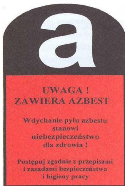
Rys. 1 Oznakowanie wyrobów i odpadów zawierających azbest, wysokość znaku powinna wynosić co najmniej 5 cm. Szerokość co najmniej 3 cm.
