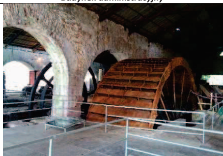
Koło wodne wewnątrz pudlingarni
